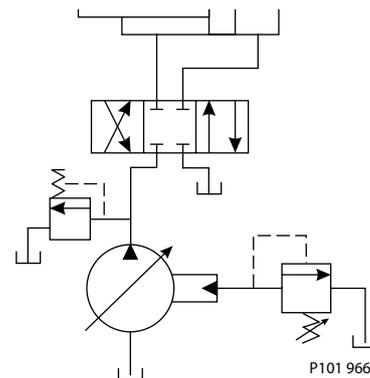
远程PC控制使用先导管路连接外部液压阀。
