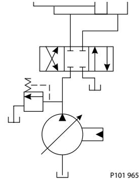
闭芯控制阀一旦工作，PC控制系统检测到压力的跌落而且通过增大斜盘角度增加泵流量。泵持续增加流量直到系统压力达到PC设定值。如果系统压力超过PC设定值，PC控制模块减小斜盘角度和流量以维持系统压力。PC控制模块持续监视系统压力及改变斜盘角度以输出和作业压力需求相对应的流量。如果流量需求超过泵的输出流量，PC控制模块是泵处于最大排量，在这个情况下，实际系统压力取决于驱动负载。
