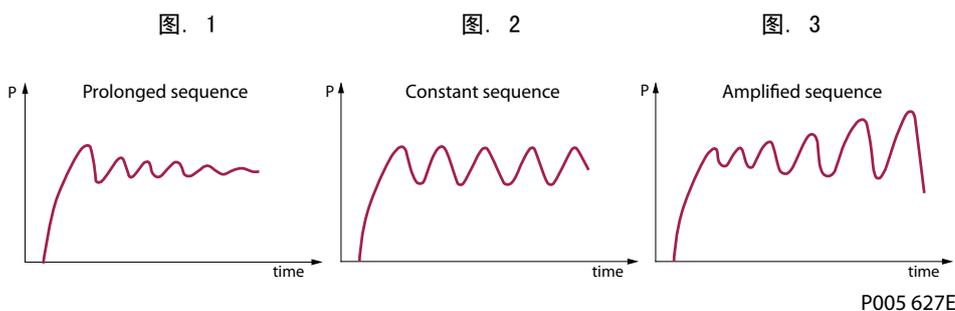
为了控制振荡现象而开发的获专利保护的的压力控制阀芯，可以把以上提到的大部分振荡问题减至最小。
