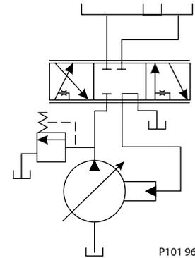
大多数负载敏感系统使用并行的、闭芯的控制阀，此阀带允许最高工作压力（LS信号）反馈至LS控制的特殊油口。
