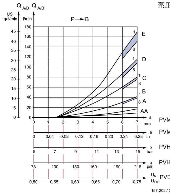
泵压和LS压力的压差 = 20 bar [290 psi].
