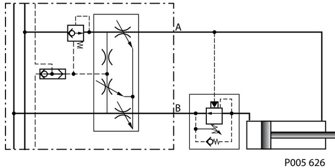
因此, 泵压力与阀芯行程有关。闭芯必须移动至泵压大于实际负载压力时才从P口向A/B口供油。
