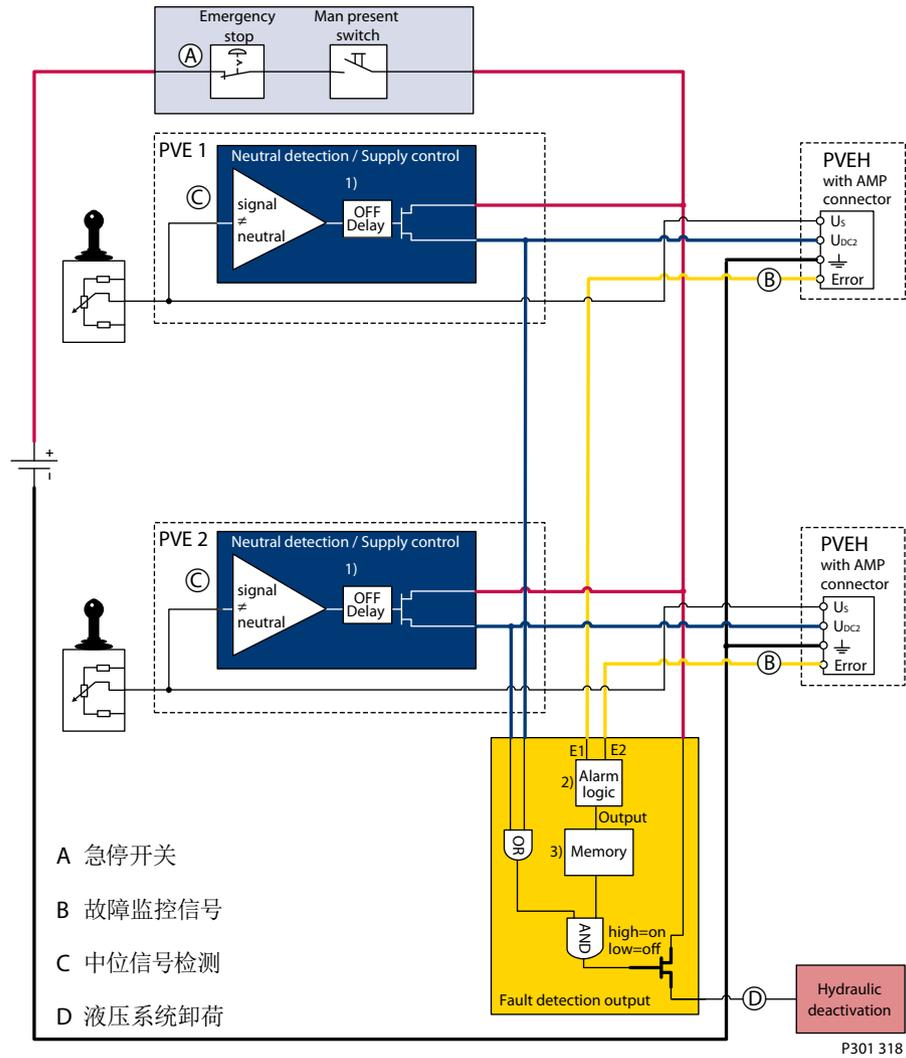
系统控制逻辑。PLUS+1用于信号监控及触发液压系统卸荷的信号。
